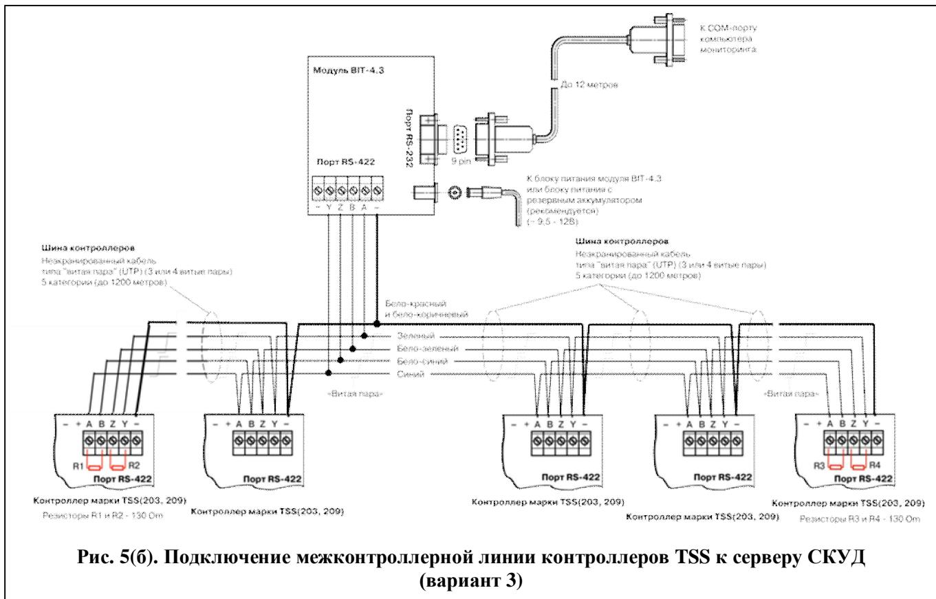
**Рис. 5(б). Подключение межконтроллерной линии контроллеров TSS к серверу СКУД (вариант 3)**
