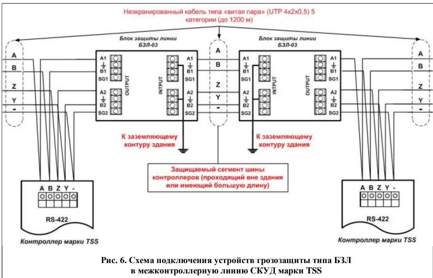
**Рис. 6. Схема подключения устройств грозозащиты типа БЗЛ в межконтроллерную линию СКУД марки TSS**
