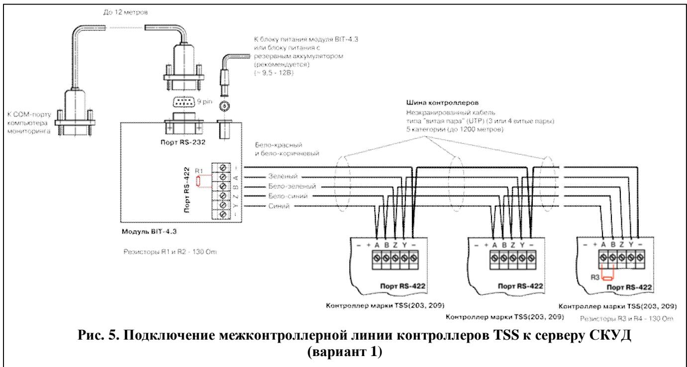
**Рис. 5. Подключение межконтроллерной линии контроллеров TSS к серверу СКУД (вариант 1)**
