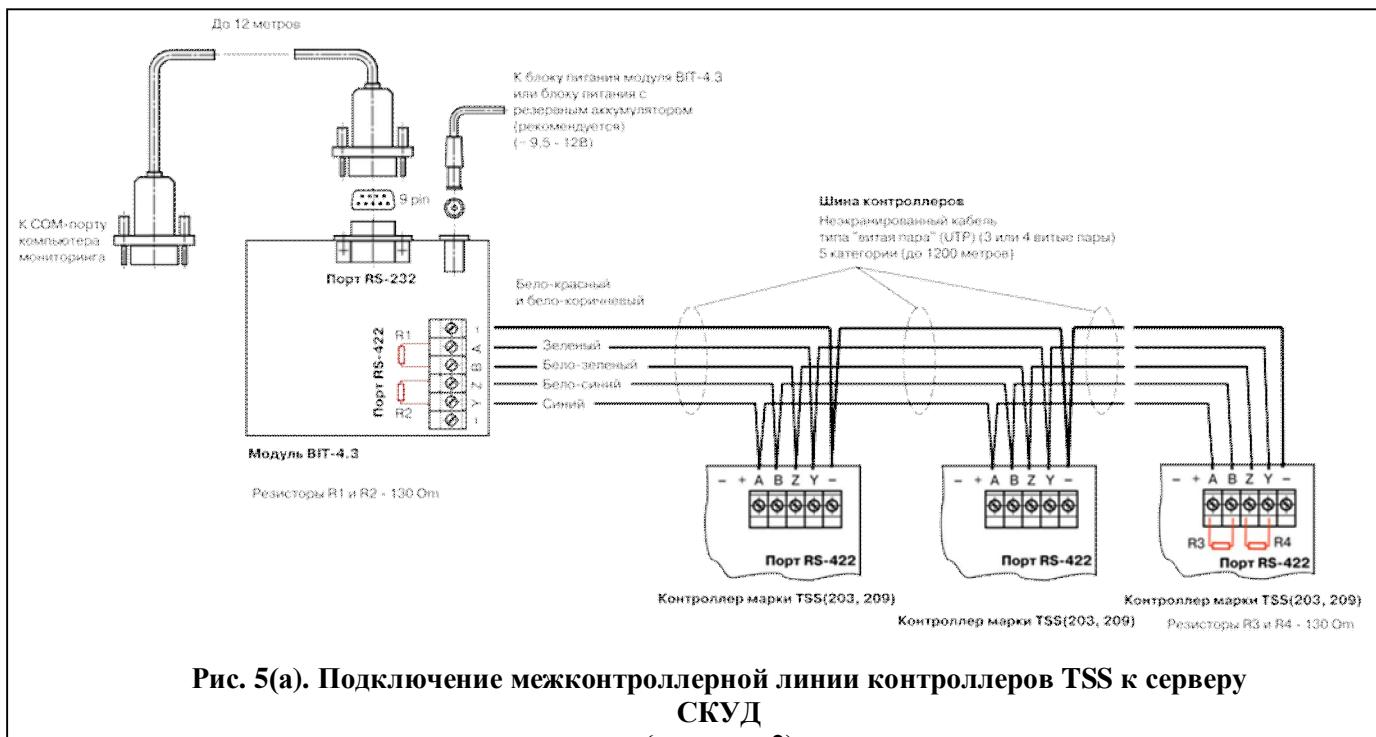
**Рис. 5(а). Подключение межконтроллерной линии контроллеров TSS к серверу СКУД**
